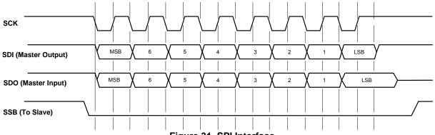
Figure 31. SPI Interface
